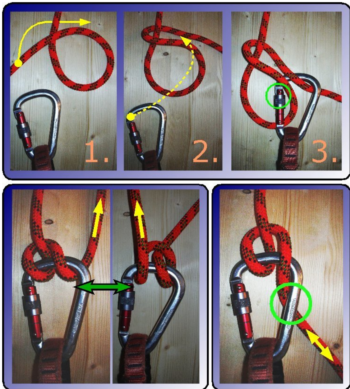
Abb. 3 Erstellung eines Halbmastwurfs , Umschlagen des Halbmastwurfs , Seilführung und Verschlusshülse
