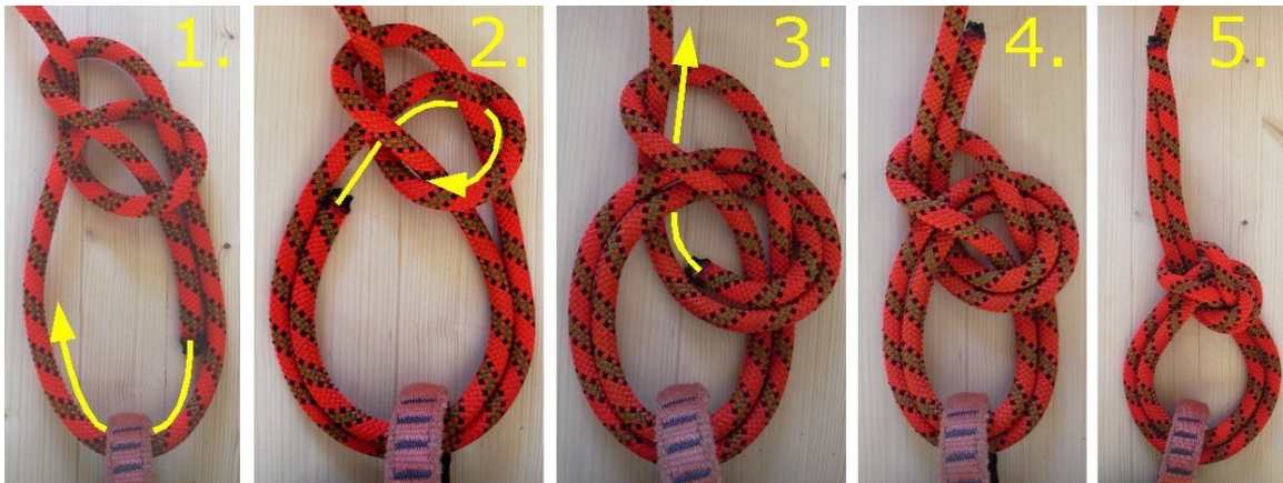
Abb. 16 Vom einfachen zum doppelten Bulin
