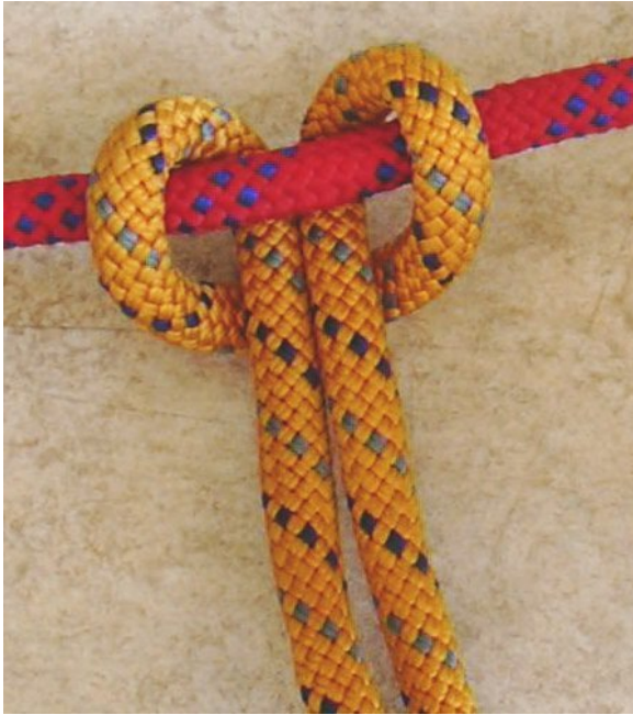
Abb. 32 Das orange Seil bildet einen Ankerstich um das rote Seil
