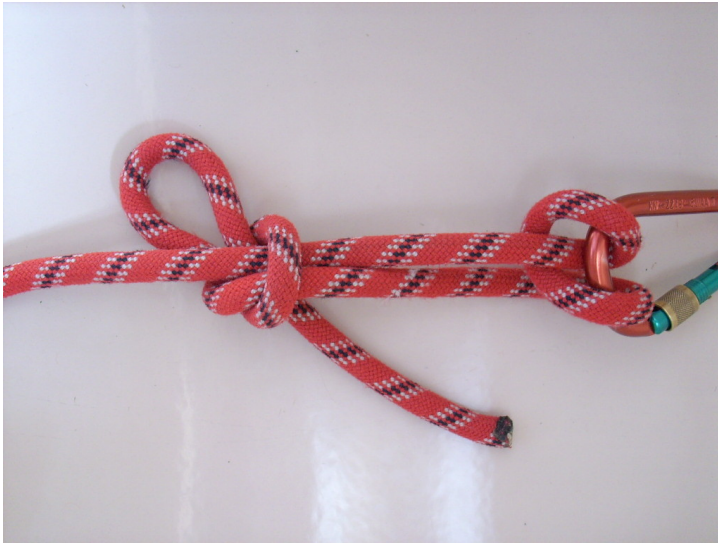
Abb. 34 Knüpfen eines Schleifknotens
