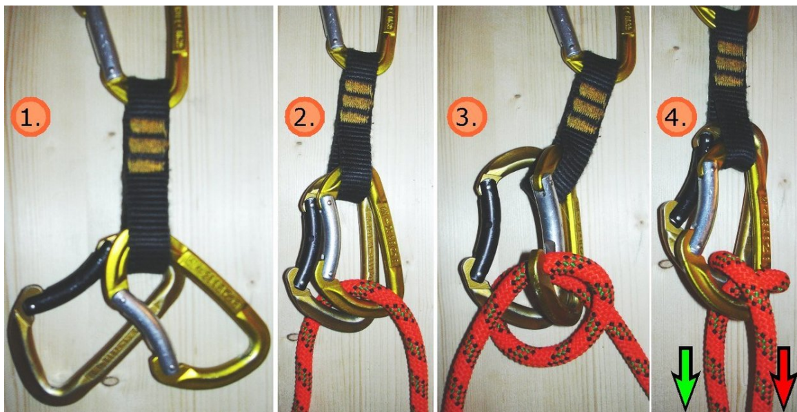
Abb. 23 Gardaknoten (auch Gardaschlinge ), gegen den Uhrzeigersinn eingelegt
